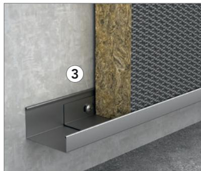
Le profil en J 40 mm (25/40/13 mm) et les pattes de support sont utilisés pour soutenir les panneaux montés au-dessus du sol. Si vous utilisez un profil en J de 1 mm, il n'est pas nécessaire d'utiliser des pattes de support.
