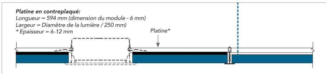
\* L'épaisseur de la platine en contreplaqué ou en métal doit être adaptée en fonction du poids, de la taille et de la position de votre équipement de service (par exemple le spot ou haut-parleur). La platine elle-même ne peut pas fléchir après l'installation de votre équipement de service.
